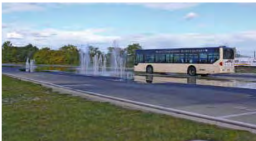
Płyta poślizgowa na torze w Teesdorf
