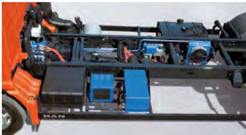
Układy hybrydowe MAN TGL zaznaczone na niebiesko
