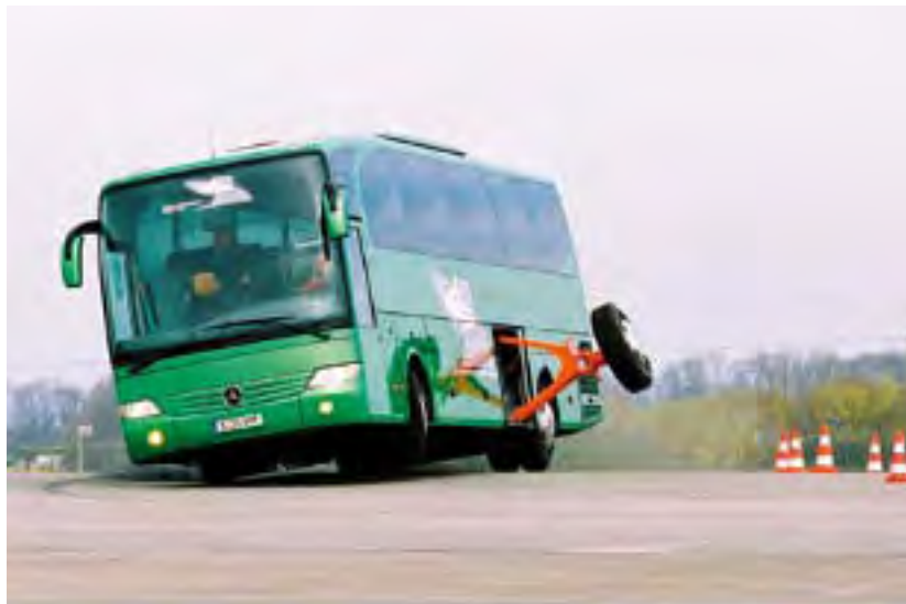
Zachowanie się Mercedesa Travego bez układu ESP
