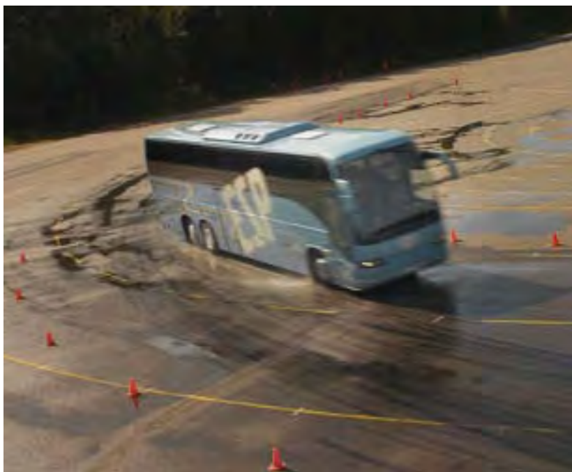
Badania układu ESP na torze doświadczalnym Volvo
