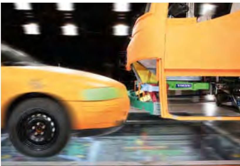
Front Underrun Protection System (FUPS) zapobiega w Volvo wjechaniu pod autobus samochodu osobowego
