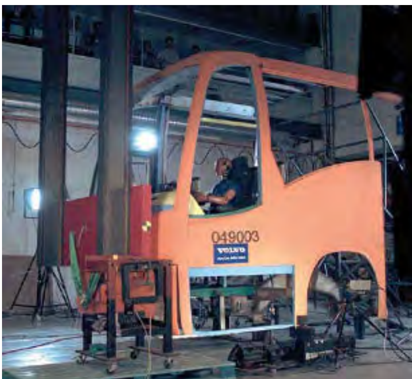
System Volvo – Front Impact Protection (FIP) – podczas testów zderzeń czołowych
