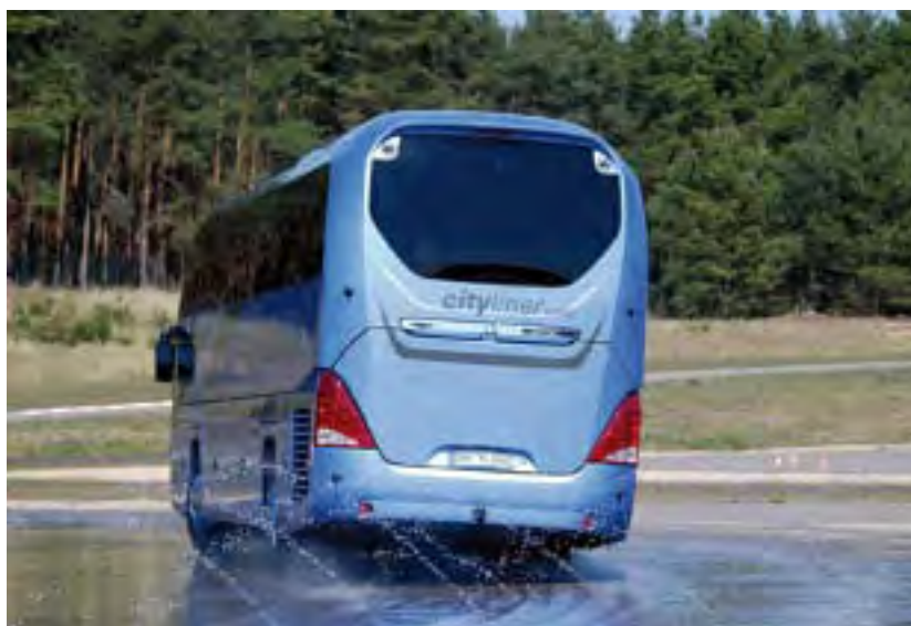
Neoplan Cityliner – badania układu CDS
