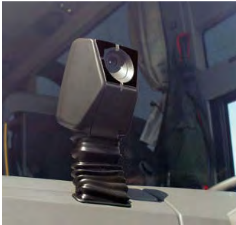
Mała kamera umieszczona nad kokpitem śledzi pasy na jezdni (system LGS)
