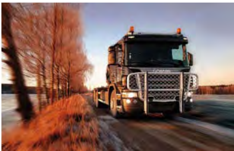
Potężna osłona z rur aluminiowych dodatkowo wyposażona w siatkę ochronną
