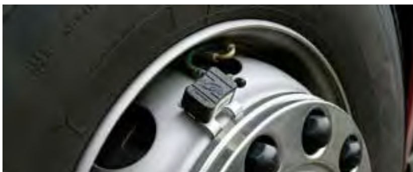
System kontroli ciśnienia w oponach można uznać za tuning podnoszący bezpieczeństwo
