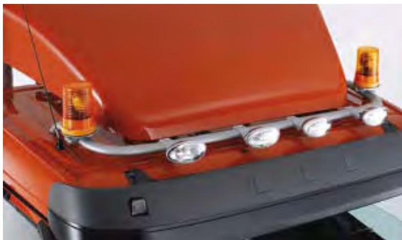
Rama dachowa służy nie tylko ozdobie, ale także spełnia funkcję praktyczną – może służyć do montażu oświetlenia ostrzegawczego
