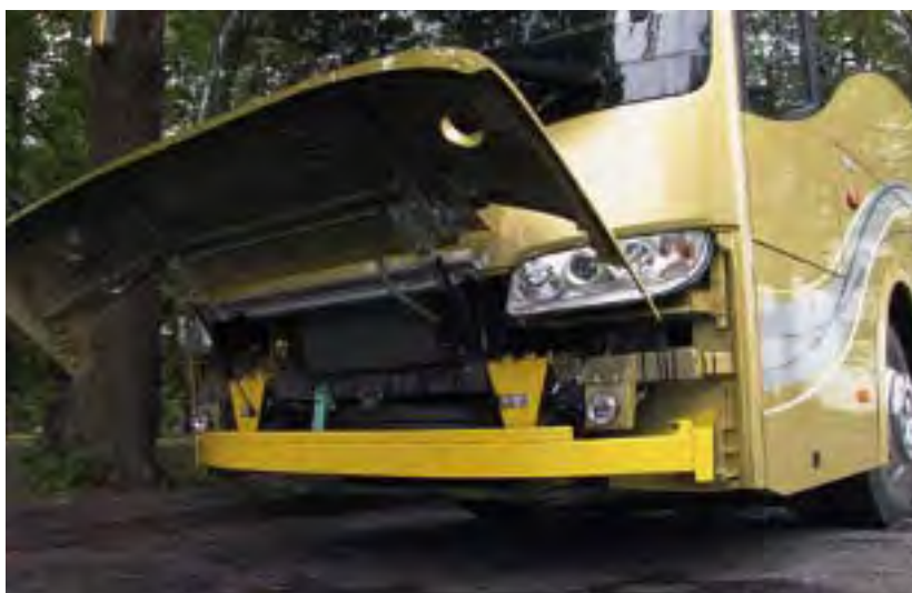
Tak wygląda belka zapobiegająca wjechaniu auta osobowego pod autobus (system FUPS)
