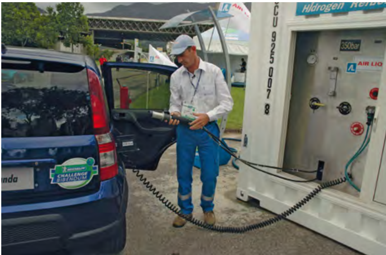
Tankowanie wodoru jest podobne do napełniania zbiornika LPG
