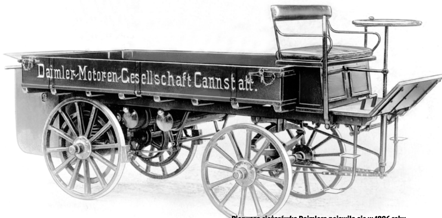
Pierwsza ciężarówka Daimlera pojawiła się w 1896 roku. Miała 1,5 tony ładowności oraz 4-konny, umieszczony z tyłu, dwucylindrowy silnik. Ten samochód został doręczony brytyjskiemu odbiorcy.
