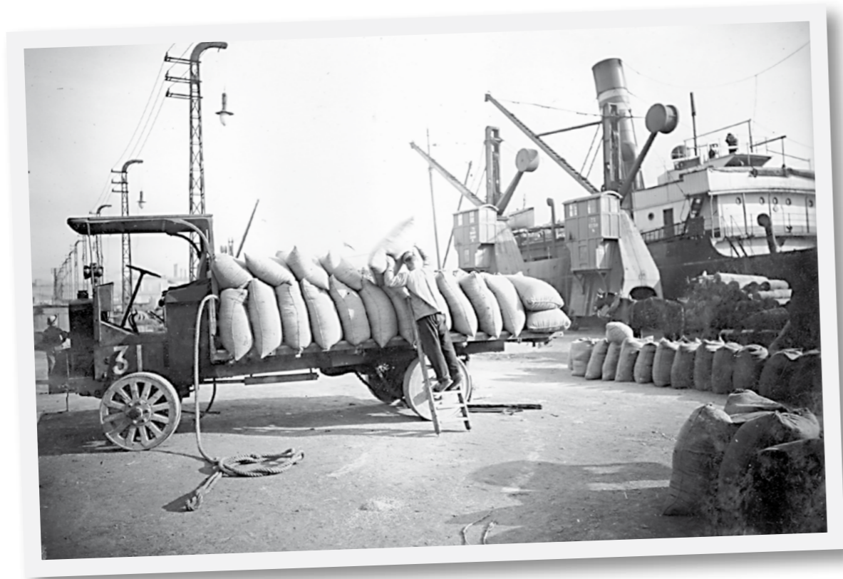
Berliet - Marseille 1909. Wczesne ciężarówki z benzynowymi silnikami mogły przewozić nawet 5 ton ładunku, ale poruszały się powoli, z reguły nie przekraczając 30 km/h
