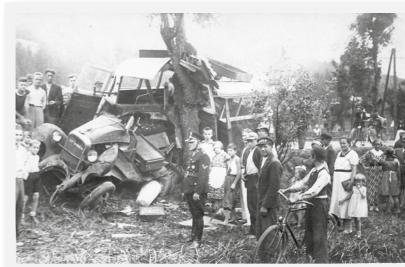
W połowie lat 30. autobus marki Citroen należący do firmy JMC roztrzaskał się o drzewo. Drewniana konstrukcja z blaszanym poszyciem rozpadła się.
