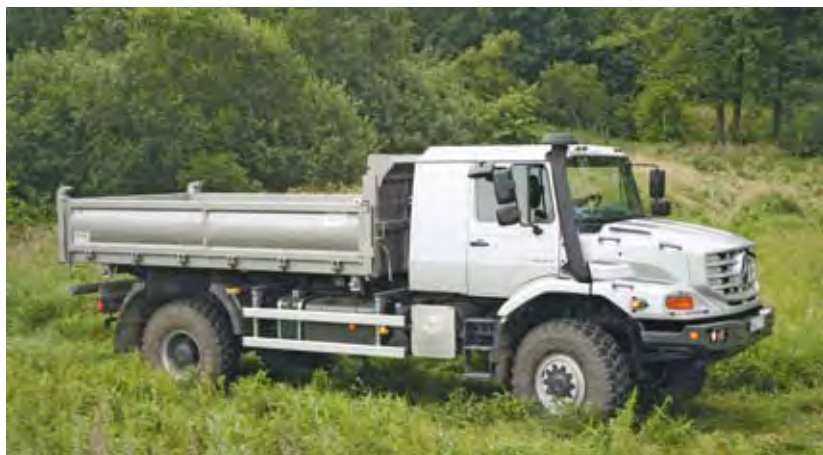
Mercedes-Benz Zetros 4x4 z lekką zabudową trójstronną W3H wykonaną ze stali 18G2A z lewą burtą hydrauliczną i prawą uchylną
