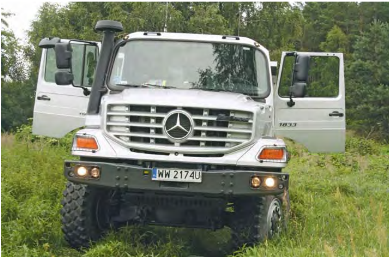
Rozstaw osi Zetrosa w prezentowanej wersji dwuosiowej wynosi 4800 mm (trzyosiowej – 4750 + 1450 mm)
