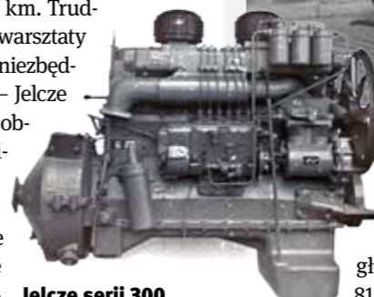
Jelcze serii 300 napędzał 200-konny silnik budowany w WSK Mielec na licencji Leylanda.
