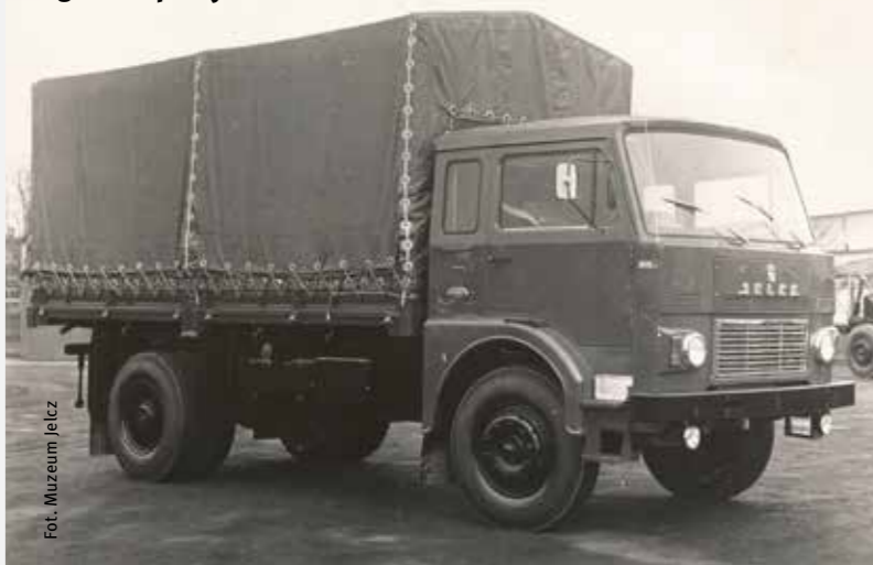
Jelcz 315 M z kabiną 113 pierwszej wersji, z gładkim poszyciem drzwi.
