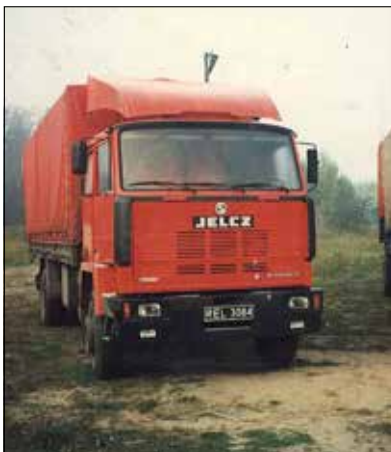
Jelcz 415 należący do firmy Styropianex z późniejszą kabiną, zamontowaną po naprawie powypadkowej.
