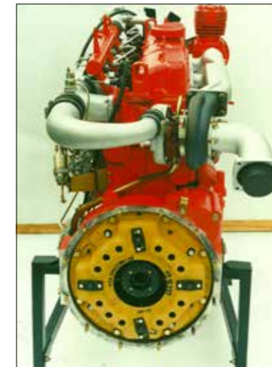
Silnik T 359 E z widocznymi oddzielnymi kanałami kolektora wydechu, doprowadzającymi do turbiny gazy wydechowe z cylindrów 1-3 i 4-6.
