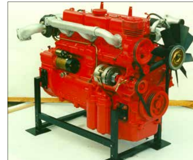
Silnik T 359 E z widocznymi oddzielnymi kanałami kolektora wydechu, doprowadzającymi do turbiny gazy wydechowe z cylindrów 1-3 i 4-6.
